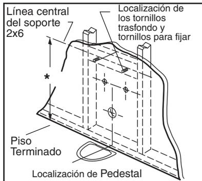
**4** Remueva el lavabo y el pedestal. En cada lugar marcado, haga una perforación pequeña para facilitar la instalación de los tornillos.
